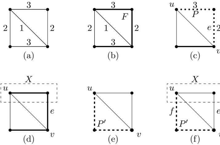
FIG. 1.64 – (a) Le graphe  $G$  et les coûts de ses arêtes, (b) un arbre couvrant  $F$  de  $G$  de coût maximum, (c) la chaîne  $P$  de  $F$  entre  $u$  et  $v$  et l'arête  $e$  de  $P$  de coût minimum, (d) la coupe fondamentale  $\delta_G(X)$  de  $G$  associée à  $F - e$ , (e) une  $(u, v)$ -chaîne  $P'$  de  $G$ , (f) l'arête  $f$  appartenant à  $P'$  et à  $\delta_G(X)$ .
