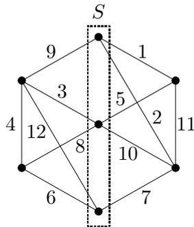
FIG. 1.68 – Le graphe  $G$ , les coûts de ses arêtes et l'ensemble de sommets  $S$ .
