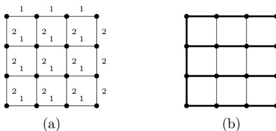
FIG. 1.71 – (a) Coûts des arêtes, (b) Au cours de la construction de l'arbre, sont ajoutées toutes les arêtes horizontales et la première arête verticale de type  $j$  pour  $j = 1, \dots, n - 1$ .
