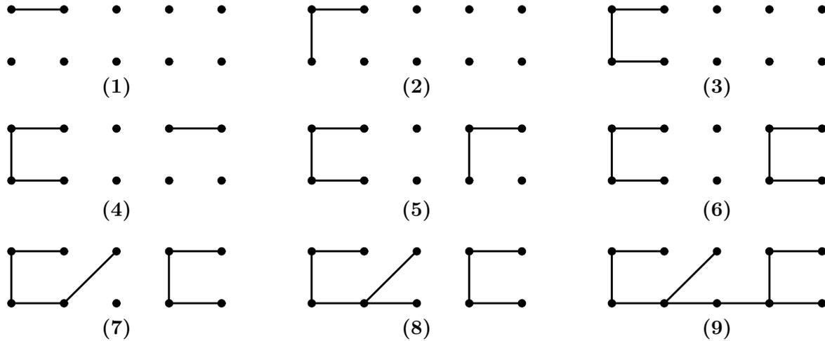
FIG. 1.56 – Déroulement de l'Etape 2 de l'algorithme de Kruskal basé sur l'ordre de la FIG. 1.55.
