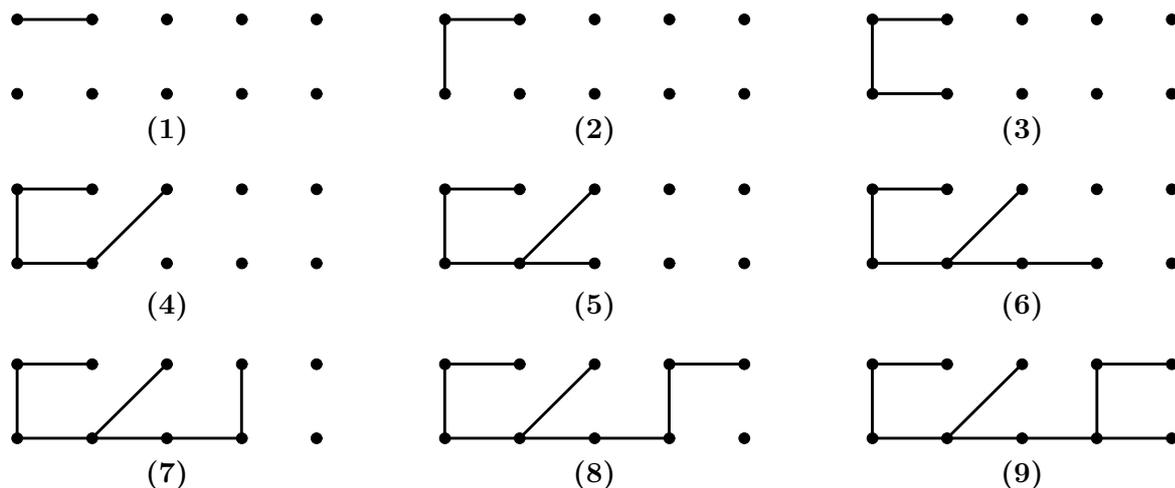
FIG. 1.58 – Déroulement de l'Étape 2 de l'algorithme de Prim
