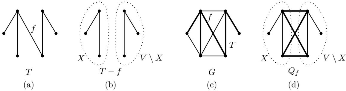
FIG. 1.48 – (a) Un arbre  $T$  et une arête  $f$  de  $T$ , (b) la bipartition fondamentale  $\{X, V \setminus X\}$  de  $T - f$ , (c) un graphe  $G$ , un arbre couvrant  $T$  de  $G$  et une arête  $f$  de  $T$ , (d) la coupe fondamentale  $Q_f$  de  $G$  définie par la bipartition fondamentale  $\{X, V \setminus X\}$  de  $T - f$ .
