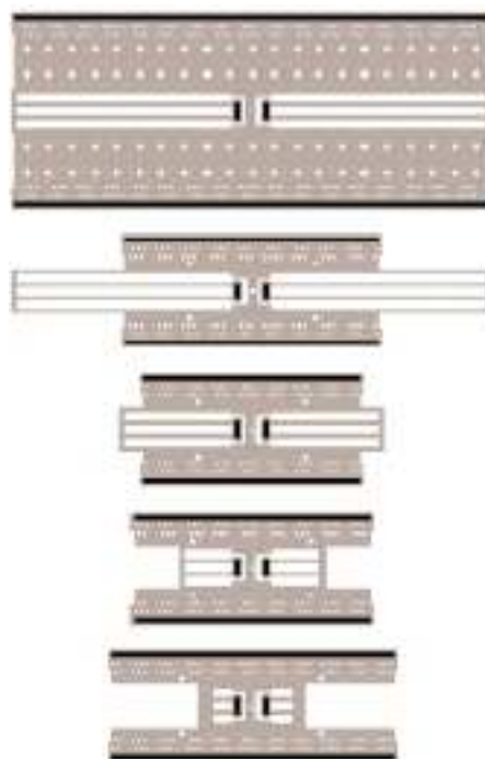
FIG. 3.21 – Génération automatique de résonateurs en fonction de spécification fonctionnelle
