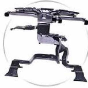
Figure 7-10. Exemple de gaine de distribution d'air (avant et arrière) pour voiture climatisée
