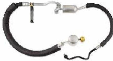
Figure 7-11. Exemple de canalisations d'un climatiseur automobile
