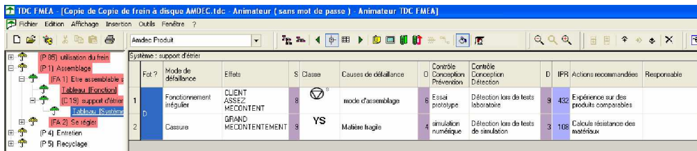
Figure 44 : Critères d’une exigence dans l’AMDEC
